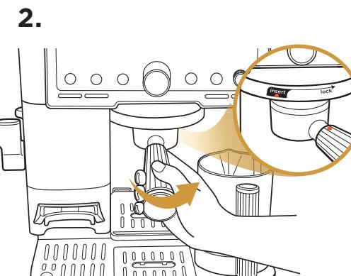
Fixez le porte-filtre pour l'aligner sur la flèche de verrouillage.
