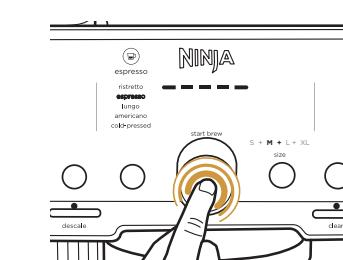
Nach Abschluss des Vorgangs ertönt erneut ein Signalton, der anzeigt, dass der Brühvorgang abgeschlossen ist. Entnehmen Sie die Tasse und dann vorsichtig den Siebträger aus dem Gruppenkopf. Entsorgen Sie das Mahlgut, indem Sie über einem Behälter oder einer Knockbox\* gegen die Oberfläche des Baskets klopfen.
