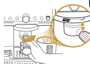
Befestigen Sie den Siebträger so, dass er auf den Sicherungspfeil ausgerichtet ist.
