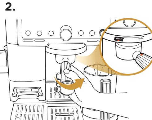
Befestigen Sie den Siebträger so, dass er auf den Sicherungspfeil ausgerichtet ist.
