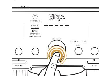
Appuyez sur **START BREW** (DÉMARRER L'INFUSION). La machine émet un signal sonore pour indiquer que l'infusion démarre. La barre de progression s'allume pour indiquer l'état d'avancement de la préparation.
