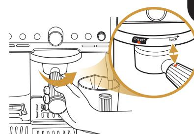
Fixez le porte-filtre pour l'aligner sur la flèche de verrouillage.
