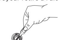
**5** Puis nettoyez le broyeur fixé à l'appareil à l'aide d'une brosse de nettoyage.
